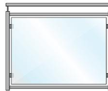
Handlauf: Stahl  $\varnothing$  34 mm
