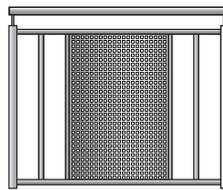
Handlauf: Stahl  $\varnothing$  42 mm
