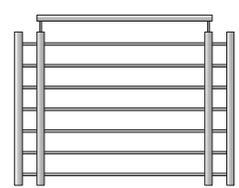
Handlauf: Stahl  $\varnothing$  34 mm
