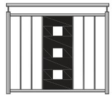
Handlauf: Stahl  $\varnothing$  34 mm
