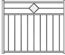
Handlauf: Stahl  $\varnothing$  34 mm
