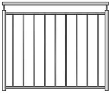
Handlauf: Stahl  $\varnothing$  34 mm
