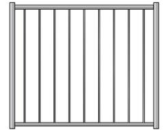
Handlauf: Stahl  $\varnothing$  34 mm
