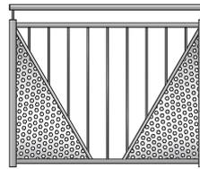
Handlauf: Stahl  $\varnothing$  34 mm
