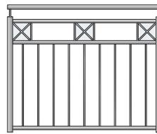
Handlauf: Stahl  $\varnothing$  34 mm
