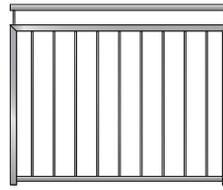
Handlauf: Stahl  $\varnothing$  34 mm
