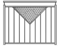
Handlauf: Stahl  $\varnothing$  34 mm
