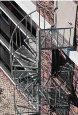
Diese Spindeltreppe aus feuerverzinktem Stahl für maximale Wetterbeständigkeit bietet eine platzsparende und langlebige Lösung für den Außen- und Innenbereich. Die robuste Konstruktion der Spindeltreppe besteht aus vier Hauptkomponenten: Zentral-Standrohr, Podest(e), Stufen und Geländer mit Handlauf.
